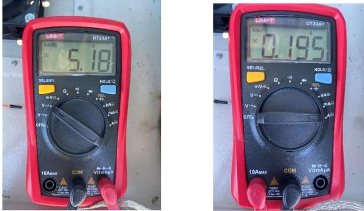
*Figura 37: Medición del consumo de la estación meteorológica de bajo costo basada en Arduino*
