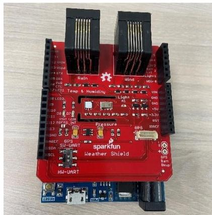
*Figura 25: Implementación Arduino weather Shield*
