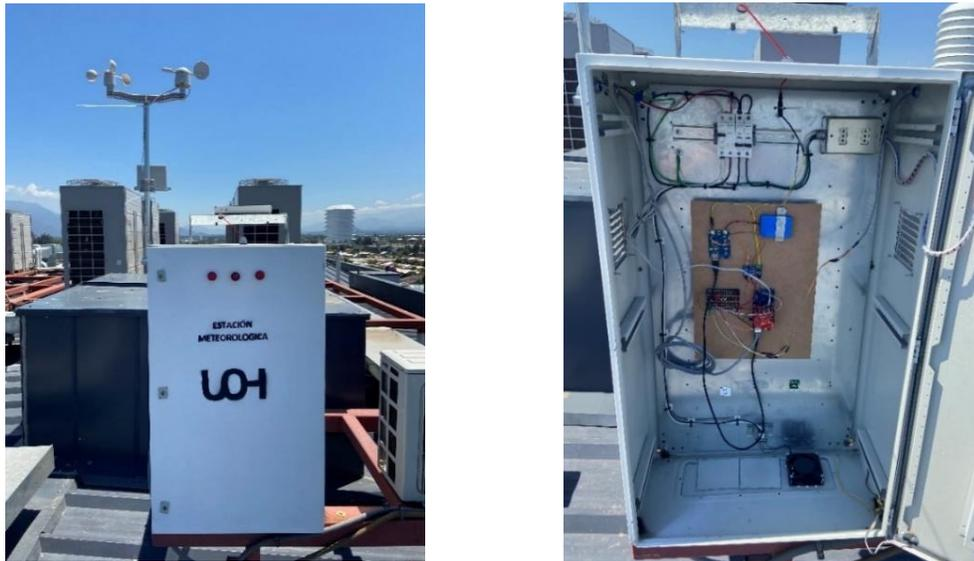
*Figura 36: Montaje gabinete y componentes exteriores e interiores*
