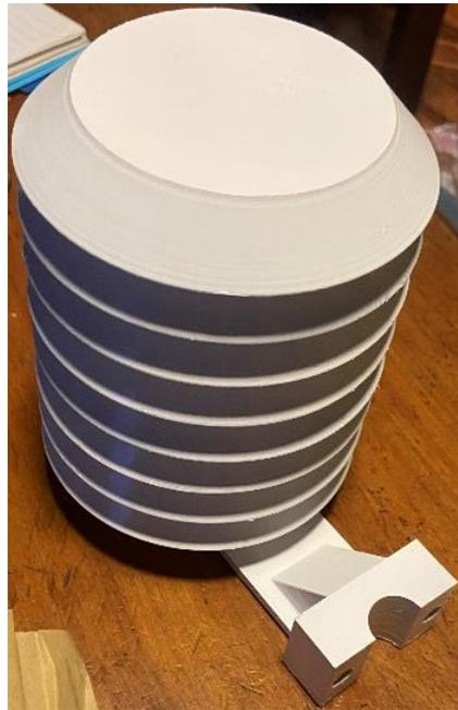
*Figura 34: Carcasa meteorológica*
