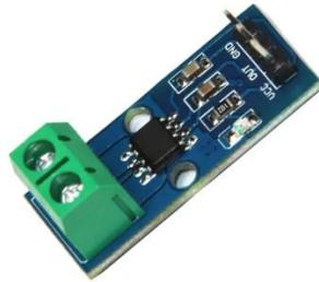
*Figura 15: Sensor de corriente ACS712*
