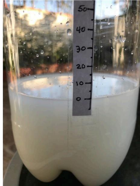
Al instalar el pluviómetro artesanal se debe llenar con agua hasta el nivel 0 de la escala. Para facilitar la lectura del nivel se puede agregar un colorante (ejemplo te o leche). La botella debe instalarse sobre una superficie horizontal, de modo que la pared quede en posición perfectamente vertical.
